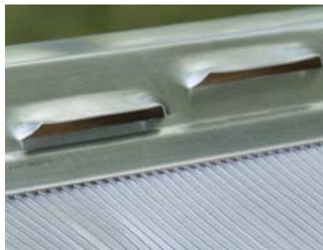
**Étanche** La technique innovante de plissage employée permet un allongement du plomb de 25 % : la bavette en plomb plissé épouse parfaitement le galbe des tuiles à grandes ondes et évite toute remontée d'eau même par vent fort.
